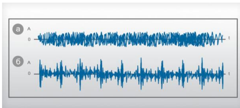
Рис. 2. Временные сигналы для исправного (а) и дефектного (б) подшипников
